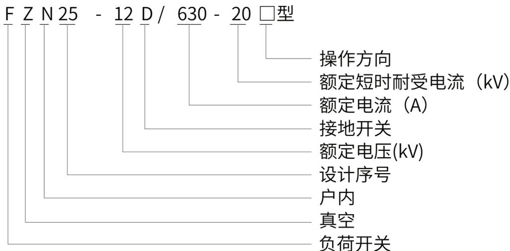
● 高压户内真空负荷开关--熔断器组合电器
